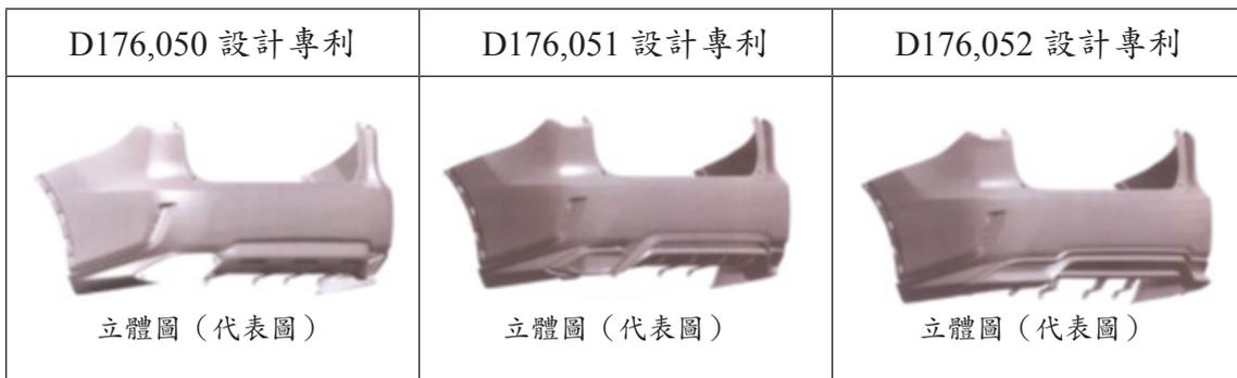
圖 18 豐田公司的後保險桿設計與衍生設計<sup>41</sup>
