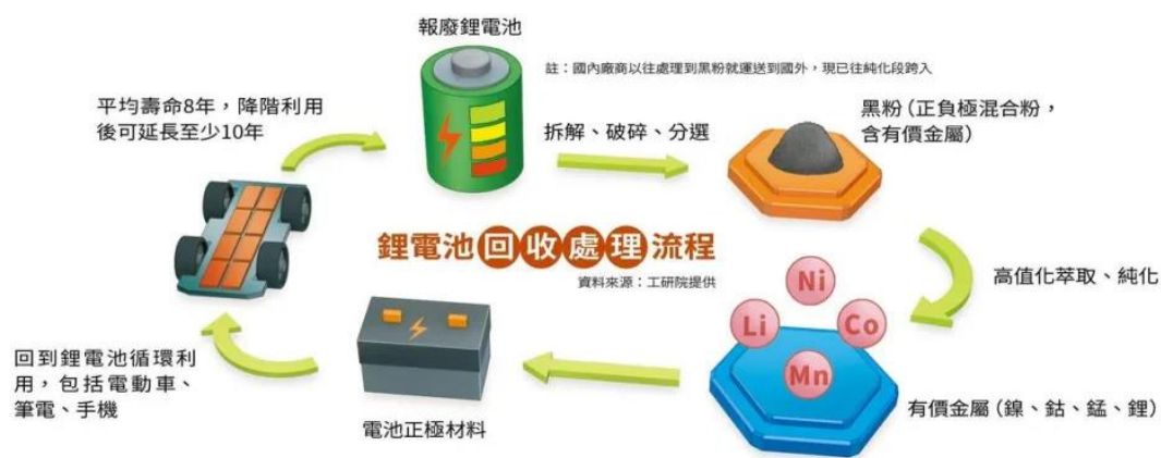
圖 3 鋰電池回收處理流程
