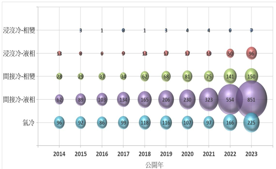
圖 17 電池散熱方式趨勢分析
