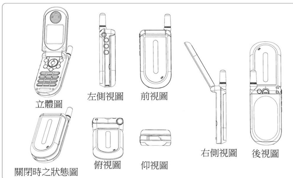
圖 3-23 基本視圖應避免揭露不同的使用狀態
