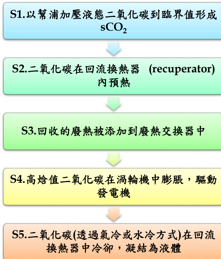
圖 2-1-13、sCO 2 發電的機制 42
