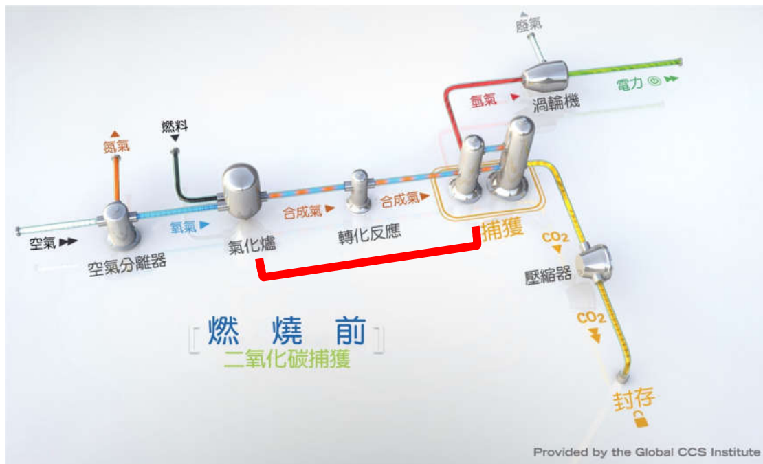
圖 2-1-15、燃燒前捕捉技術（氣化水轉化反應）機制 47
