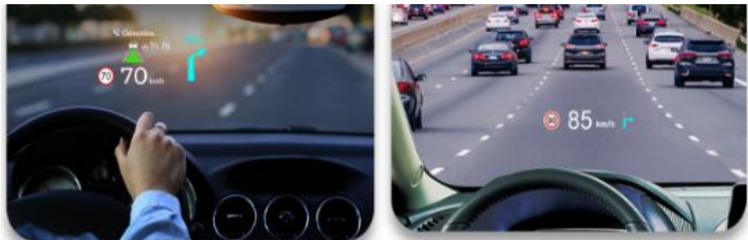
圖 10 擋風玻璃式(Windshield Type)HUD
