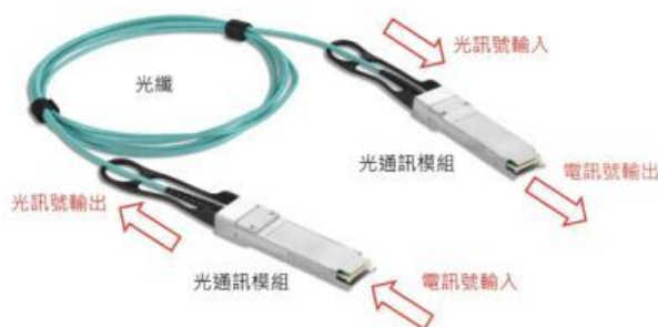
圖 14、插拔式光收發模組實物圖二
