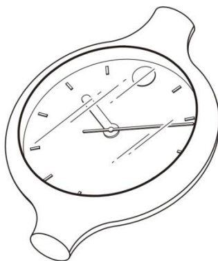
圖 1-17 具透明材質之物品的表示方式
