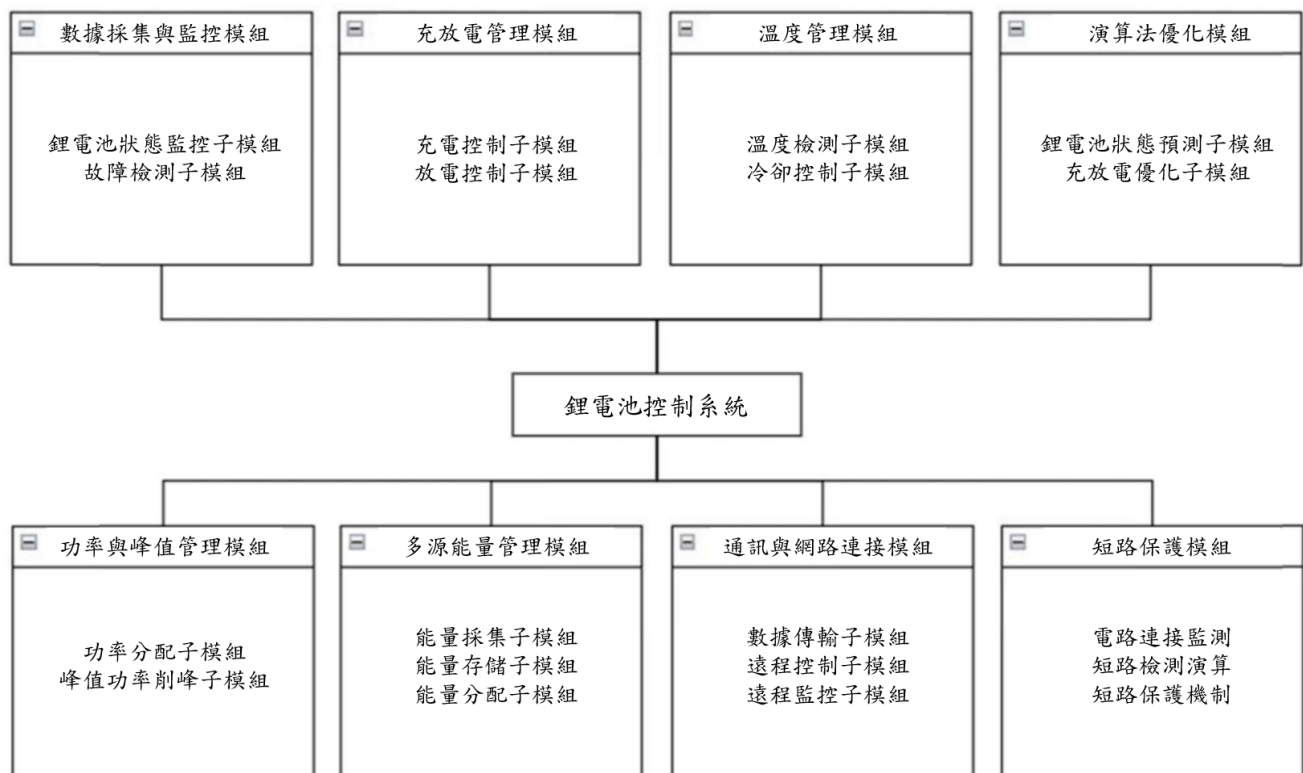
圖 80 鋰電池控制系統的主系統框架圖
