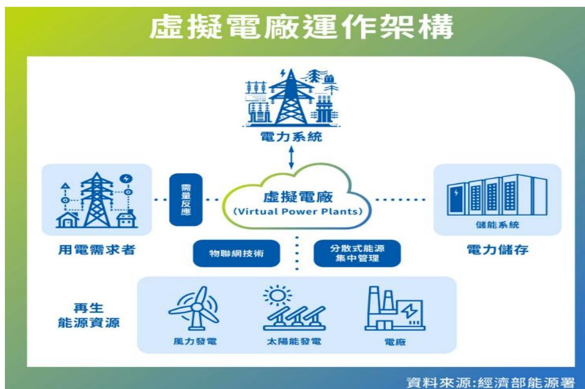
圖 18 虛擬電廠運作架構圖 49
