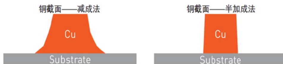
圖 16 減成法線路銅截面(左)與 mSAP 製程的線路銅截面(右)的差異 77
