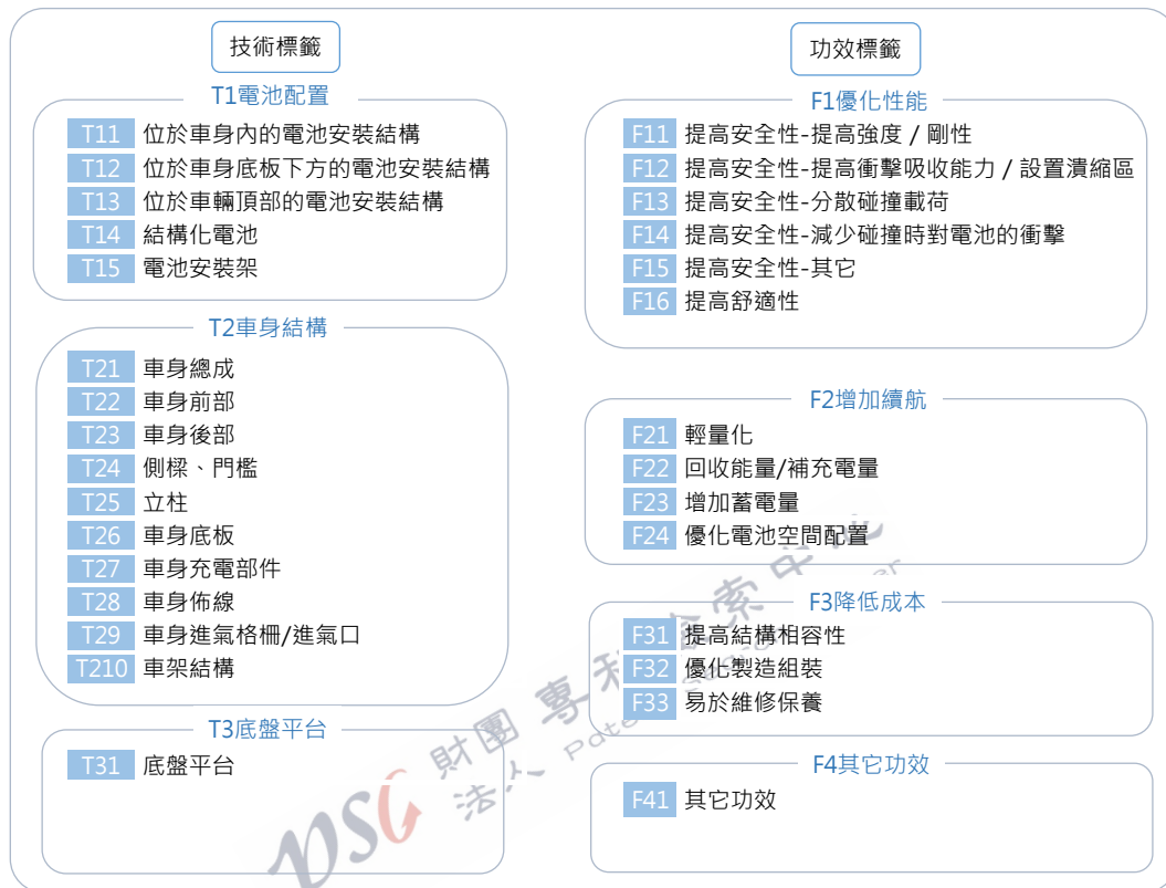
圖 34 BEV 車體結構專利技術/功效標籤說明圖
