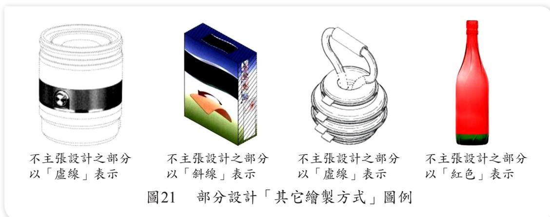
圖21 部分設計「其它繪製方式」圖例
